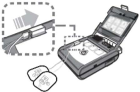
電極パッドのコネクタを本体の電極パッド
